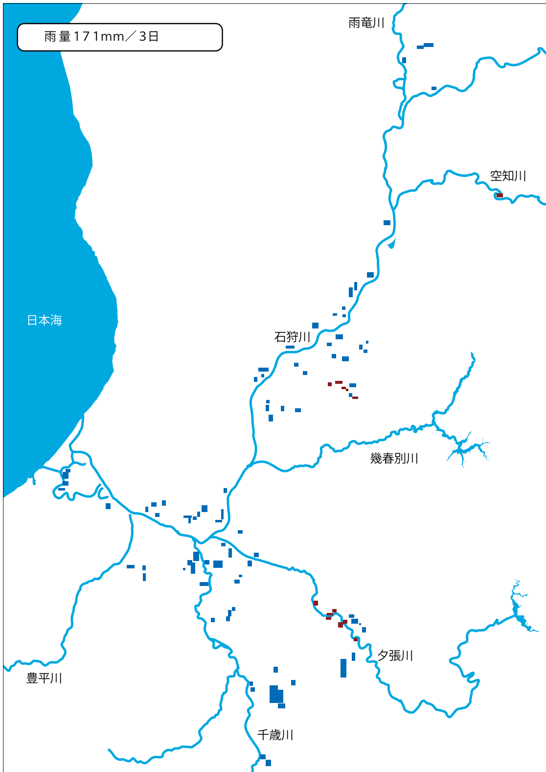
図3 平成13年の洪水による洪水実績図 図1と比べると大きく浸水域が減少している。また直線化や支流の切り替えが行われているようすもわかる (「石狩川水系 石狩川(下流)河川整備計画」(北海道開発局)を基に作図)
