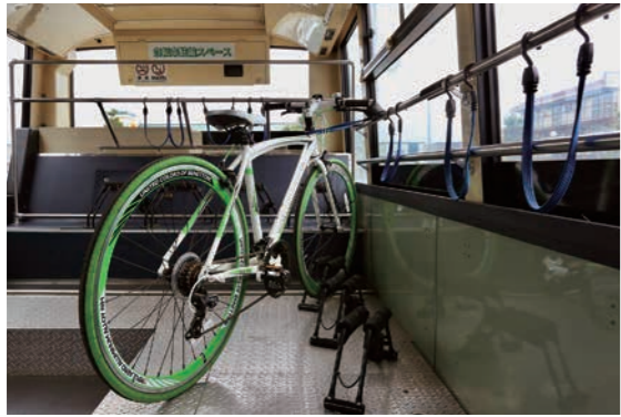
駐輪場のように、車輪止めが10箇所設置された車内。
