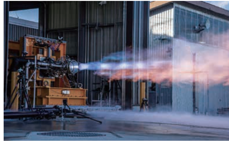
「ZERO」のエンジン「COSMOS」の燃焼器単体試験。今回の試験では、家畜のふん尿から製造した液化バイオメタンを燃料として使用。
