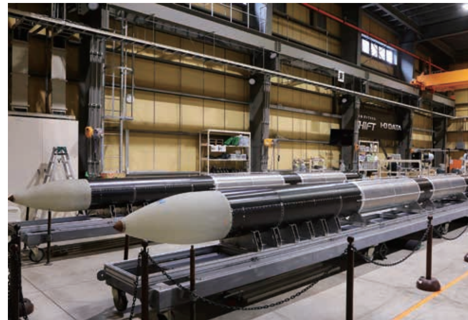
MOMO(写真)は、長さ10.1m、直径0.5mの観測ロケット。小型人工衛星を搭載するZEROは長さ32m、直径2.3mのサイズとなる。
