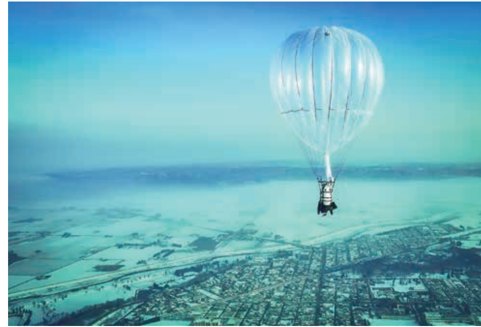
丈夫なプラスチック製の「高高度気球」で、これまで延べ300回以上の打ち上げ実績があり、現在も月に数回以上の打ち上げ実験を実施し、慎重に安全性の検証と技術開発を進めている。
