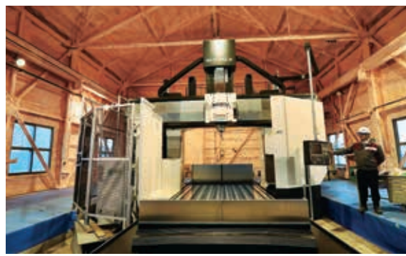
経産省からの補助金で導入された、オークマ社製の最新の5面加工門形マシンセンター。
