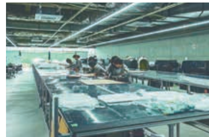
気球は、プラスチックの素材を型紙に合わせて裁断し、熱で融着させて製造。江別工場にはメイト(従業員)12名が常駐し、気球製造や天頂弁の取り付けなどを行っている。
