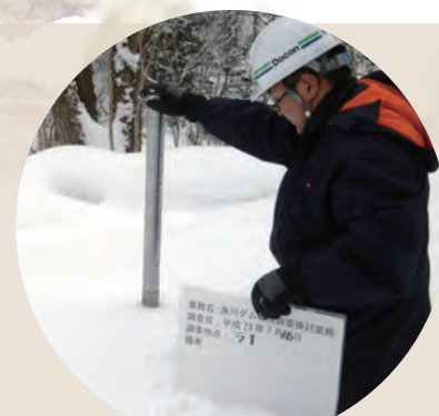
スノーサンプラー(金属製の円筒)による積雪調査
