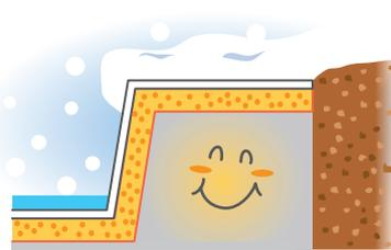
中込材の保温効果により既設水路の凍害を抑制します
