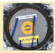
試作品断熱マンホール蓋 二重蓋型(薄厚、シート型) 平受\*設置型
