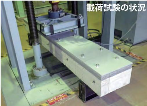
実験供試体を用いた載荷実験を実施した結果、FRPM板とポーラスコンクリートを配した本更生工法では、コンクリートのみの場合と比較して補強効果があることを確認しました。
